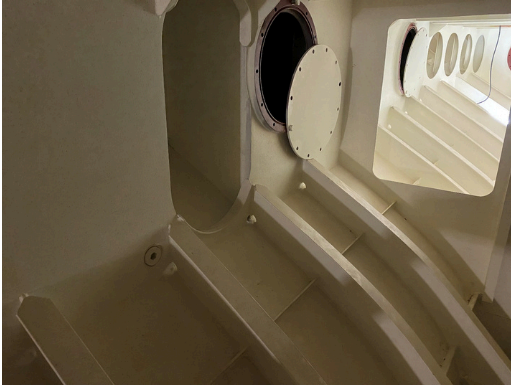
De machinekamer met spanten, kofferdam en geïntegreerde tanks
